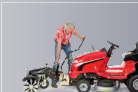
2 sec. Het werktuig aankoppelen. (geen gereedschap nodig)
